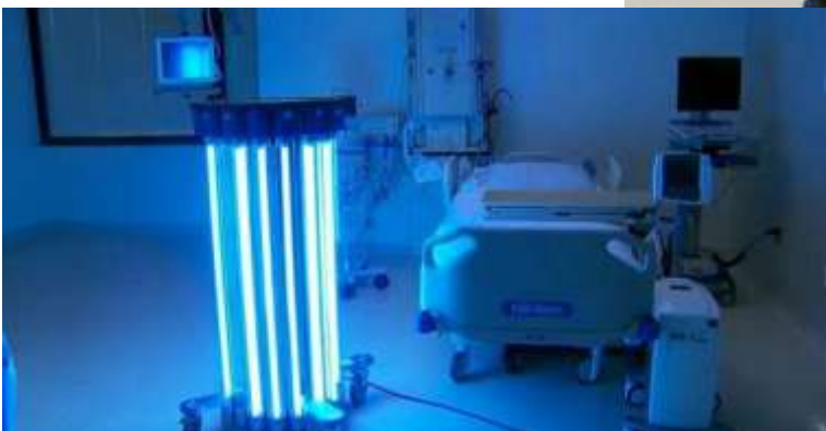
دستگاه از بین برنده و بیروس و باکتری برای اماکن عمومی تولید شد
